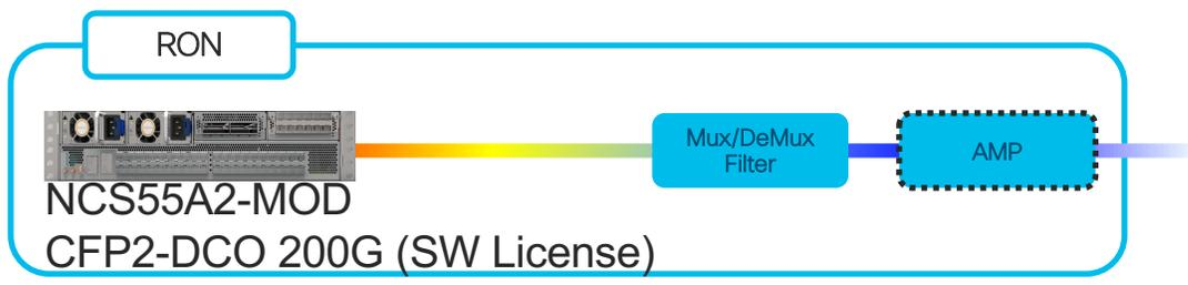
Routerへのリモートオペレーションによる帯域拡張が可能で入局が不要に。一連の拡張計画/作業を簡素化、最適なタイミングで200G化への投資が可能となり費用対効果の向上に貢献
